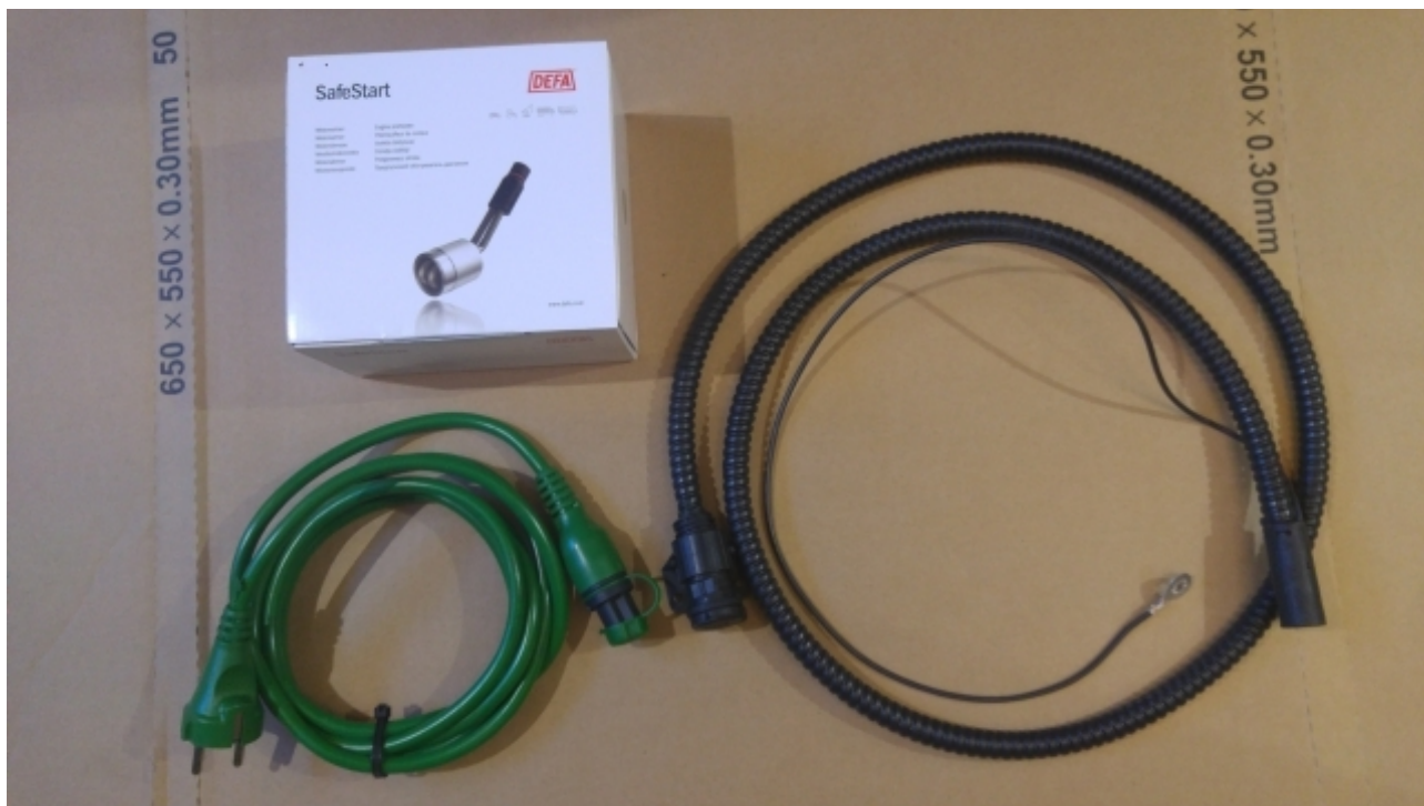
Elementy zestawu: grzałka Defa model 412880, czarny kabel wewnętrzny z gniazdem (tu wystarczyło 1,5m) i zielony kabel zewnętrzny 2,5m z wtykiem 230V i wtykiem do czarnego gniazda w aucie.
